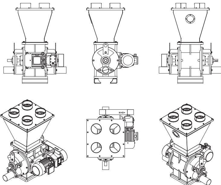
Hububat, taneli ürün ve un vs. ürünlerin pnömatik taşıma hatlarına aktarılması ve siklon seperatörlerden boşaltılması için kullanılır. Ayrıca negatif basınçla çalışan filtre ve toz siklonlarında toz toplayıcı ve hava kesici olarak kullanılabilir.
